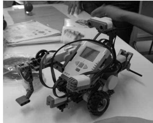
Figura 2. Jugador de Golf: localiza la pelota de su color y la golpea. Utiliza los tres motores y sensores de ultrasonidos, luz y contacto.
