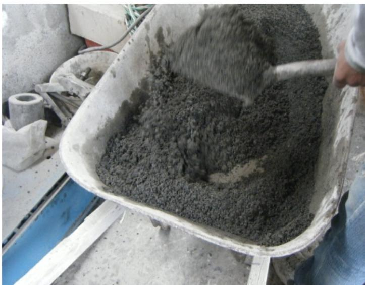
**Fig. 1** Mezcla de los materiales del bloque diatérmico cementado
