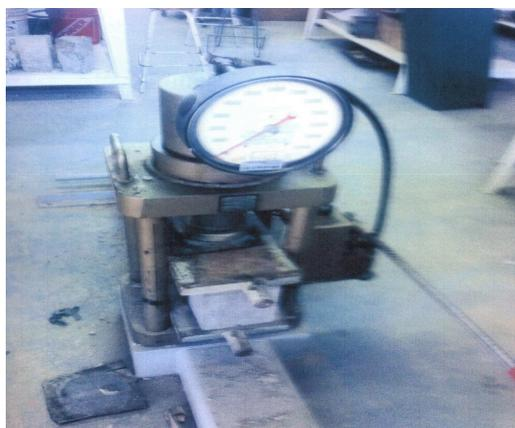
**Fig. 4** Prueba de resistencia mecánica del bloque diatérmico cementado.
