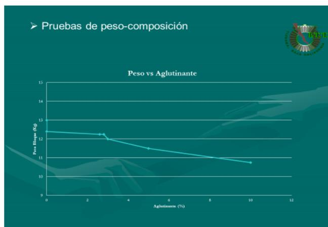
Fig. 9 Gráfica de peso – composición con diferentes porcentajes de agregado.
