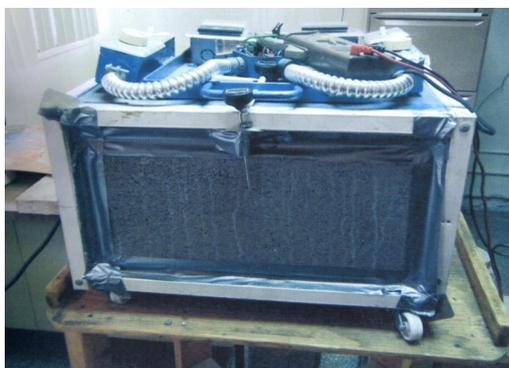
**Fig. 5** Prueba de conductividad térmica del bloque diatérmico cementado
