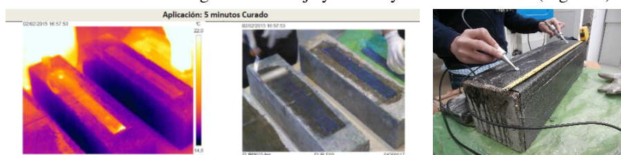
Fig. 1 Ensayos no destructivos de termografía infrarroja y ultrasonidos realizados en probetas
