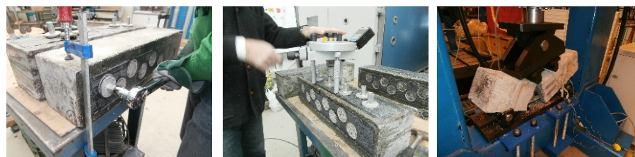
Fig. 2 Ensayos destructivos Pull Off y Shear Torsion realizados en probetas
