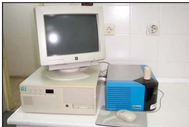
**Figura 4.5.** Espectrofotómetro Color-view™ BYK-Gardner, modelo 9000.
