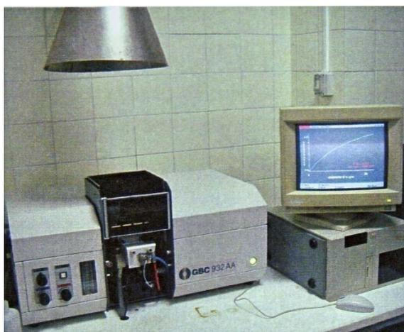
**Figura 4.8.** Espectrómetro de absorción atómica GBC modelo 932 AA, utilizado para la determinación de minerales en pulpa.
