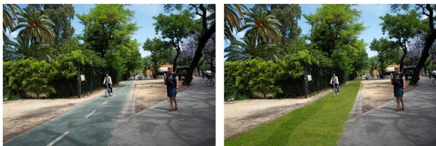
**Fig. 6** Hipótesis carril bici formado por superficie continua permeable de hierba artificial consistente en una moqueta industrial prefabricada con plástico y materiales sintéticos, concretamente fibras de polipropileno, con una alta capacidad de reciclaje y sistema de recogida de agua
