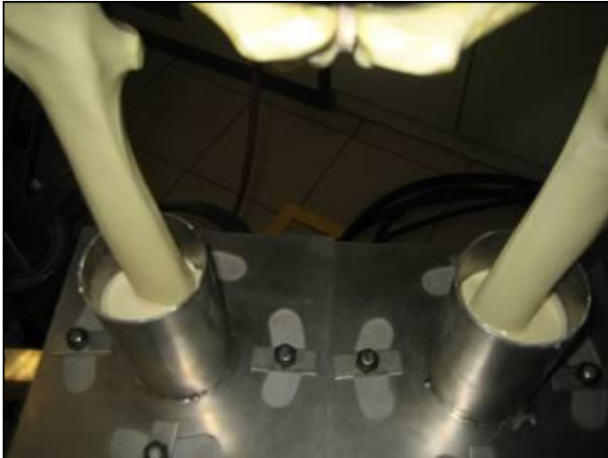
Fig. 31c: Detalle de las bases al montarlas en la máquina de ensayos. No existe separación alguna que permitiera rangos de movilidad en rotación.
