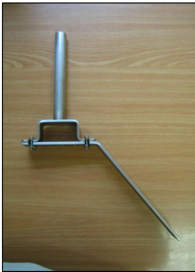
Fig. 21: Foto del sistema puente-pletina con orificios laterales fabricados.
