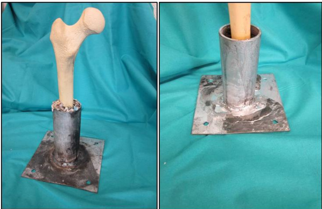
Fig. 29b: Primer testado con Resina de Poliéster. Se confirma buena rigidez del sistema.
