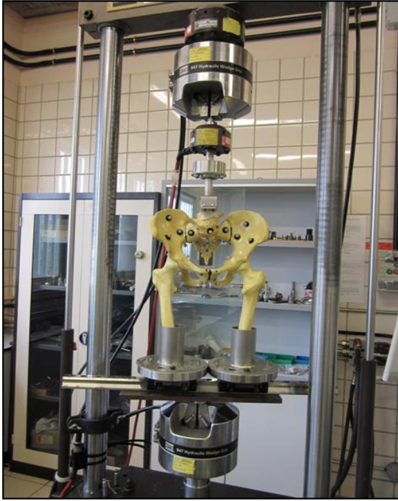
Fig. 41: Sistema de fijación de pelvis-fémures a la máquina de ensayo.
