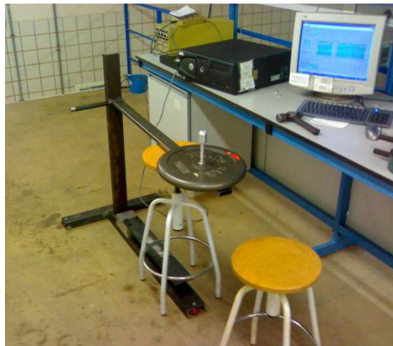
Figura 4. 20. Modelo de equipo de medición basado en el desplazamiento vertical de la antepierna a partir de la utilización de bandas extensométricas.
