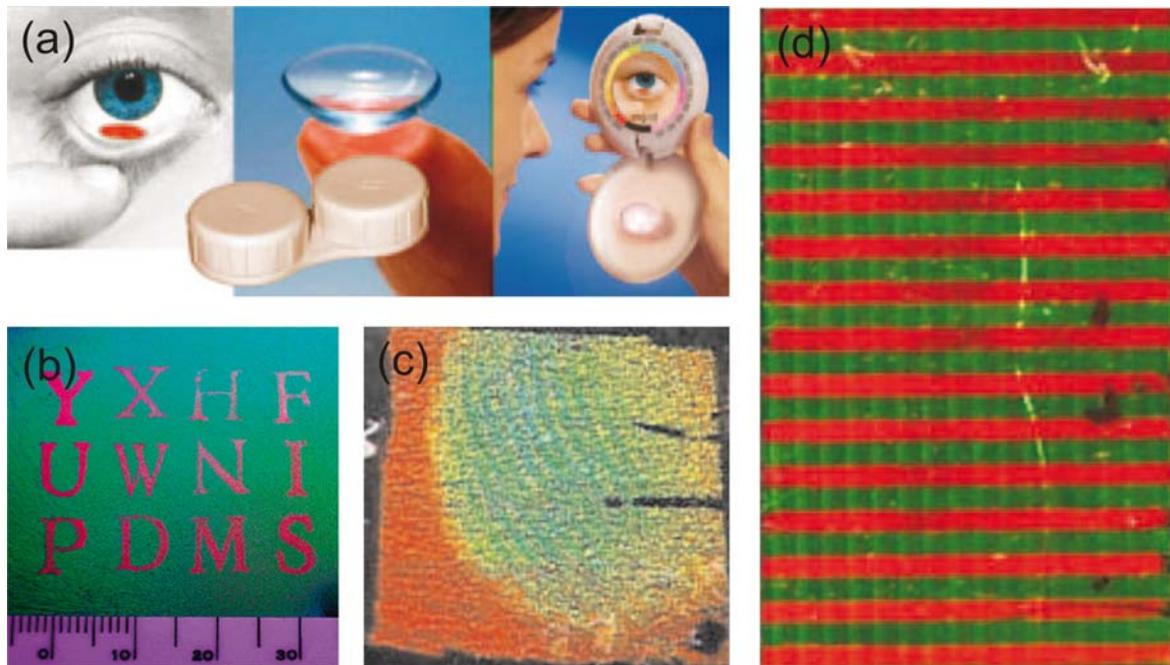
Fig. 8. Imágenes de algunos de los dispositivos basados en cristales coloidales. (a) sensores de glucosa implementados en lentillas, (b) papel, (c) sensor de huellas dactilar y (d) pantalla fotónicos. Extraídas de las Refs. [92], [94], [96] y [97], respectivamente.
