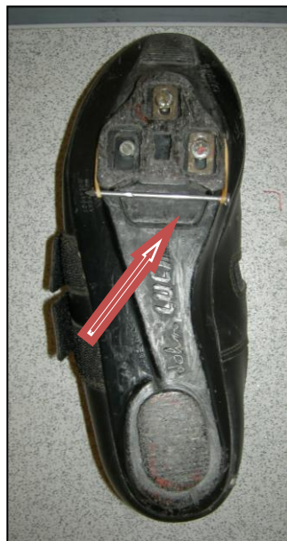
Figura 7: Colocación del elemento metálico identificador de la angulación
