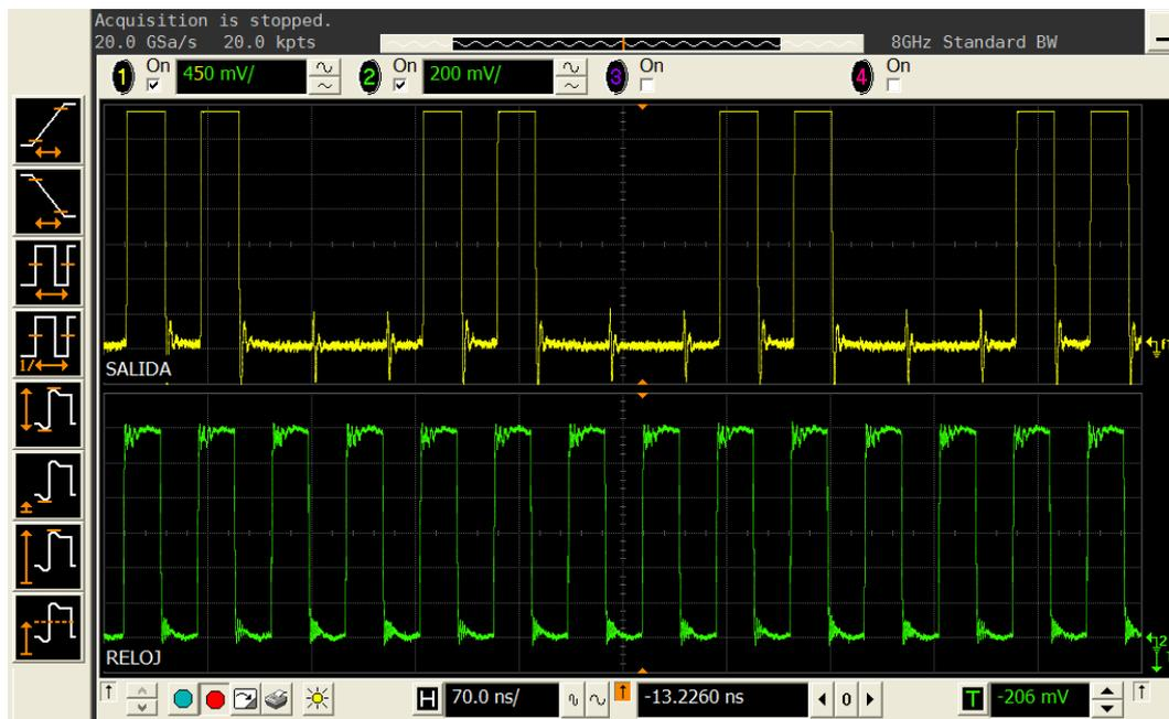
**Figura 4.8:** Inversor binario activo por flanco de subida con dimensionamiento A empleando un reloj a 20MHz y entradas conmutando a 10MHz.
