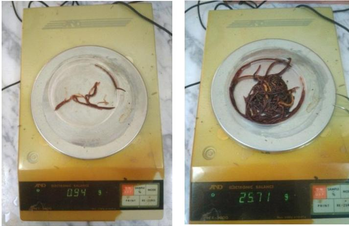
**Fotografía 11.** Comparativa de la biomasa de 20Pe80C y 100Pe. La primera con gran cantidad de cascarilla de arroz y la segunda sin cascarilla. Pe: Paja peletizada; C: Cascarilla de arroz.
