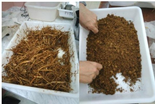
**Fotografía 3.** Paja inalterada y paja peletizada utilizada en el ensayo.
