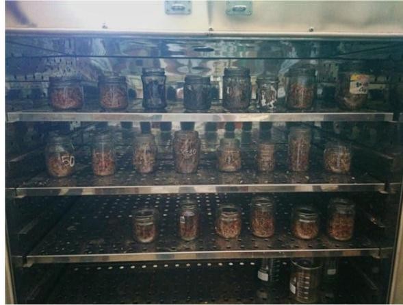
**Fotografía 7.** Muestras en estufa para determinación de la humedad.
