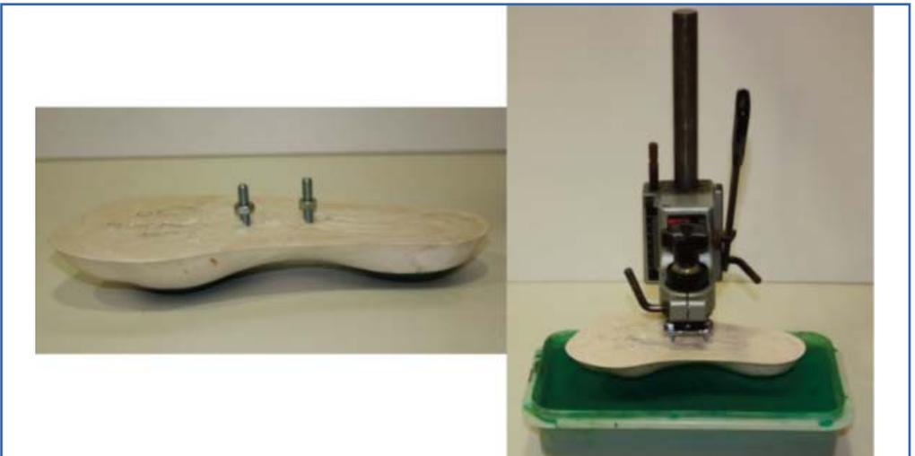
Figura 58 a,b. Método de sujeción del molde al soporte del taladro. Imagen propia.
