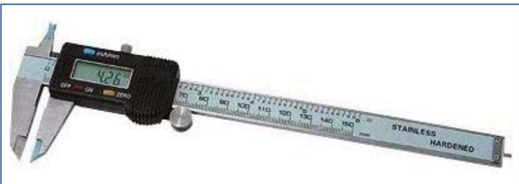
Figura 35. Imagen del calibre digital. Imagen propia.
