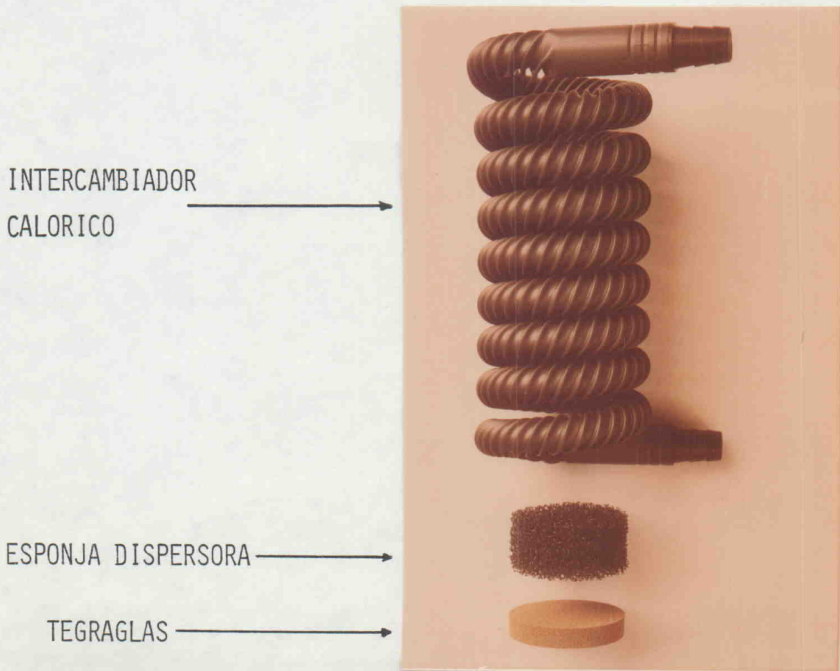
FIGURA N°6: ESQUEMA DEL OXIGENADOR, INTERCAMBIADOR CALORICO Y MATERIAL DISPERSOR. (COMENTARIOS EN EL TEXTO)
