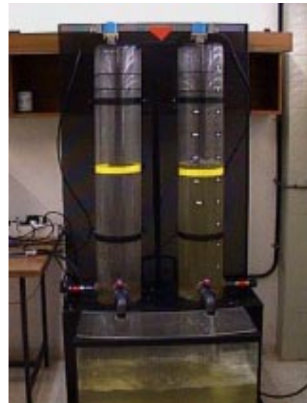
Fig. 4: Planta prototipo para controlador de nivel fuzzy.
