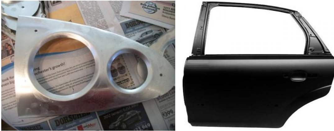
Figura 1.17- Ejemplo de aplicaciones del conformado de flancos. (Costilla de avión y puerta de automóvil respectivamente)
