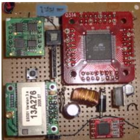
Figura 103: Dispositivo de localización de hardware específico desarrollado en el año 2008
