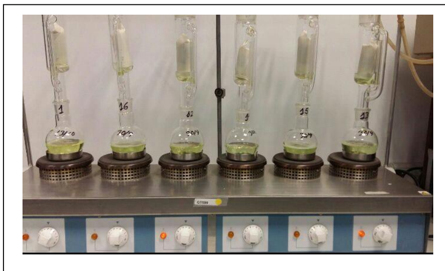
Figura 8. Soxhlet con muestras.
