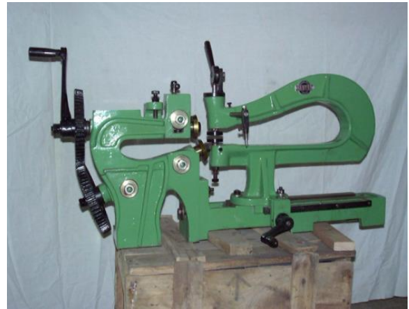
Figura 3.3 Cizalla de corte circular diseño portátil
