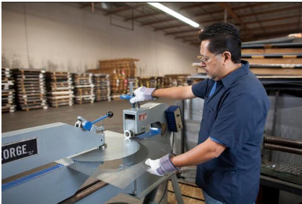
Figura 3.8 Operario trabajando con una cizalla circular de chapa
