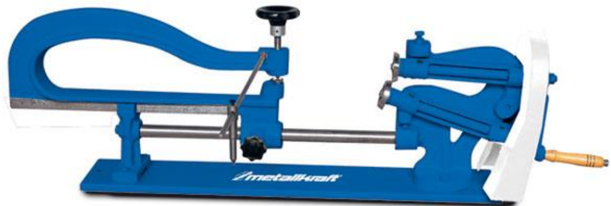
Figura 3.4 Cizalla circular Metalkraft modelo KS 1
