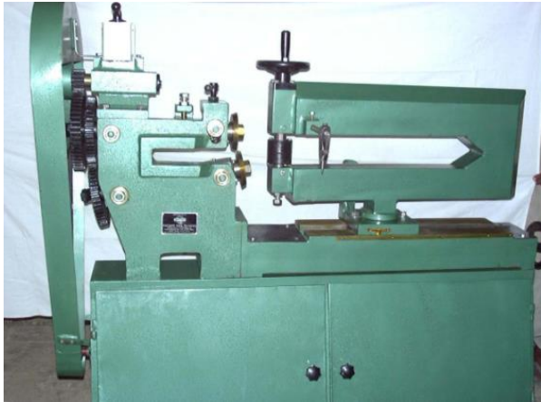
Figura 3.2 Cizalla de corte circular diseño fijo
