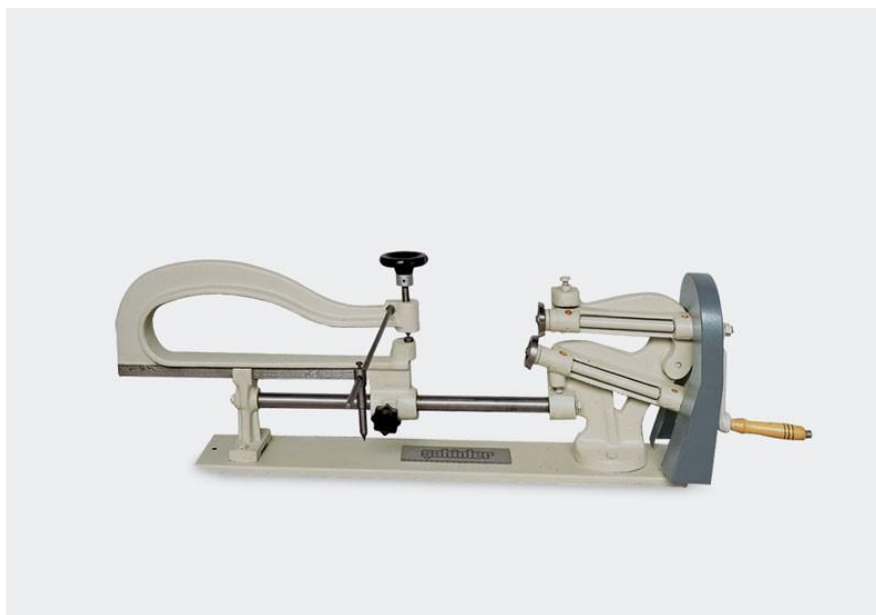
Figura 3.1 Cizalla circular manual para chapas metálicas IDK 1
