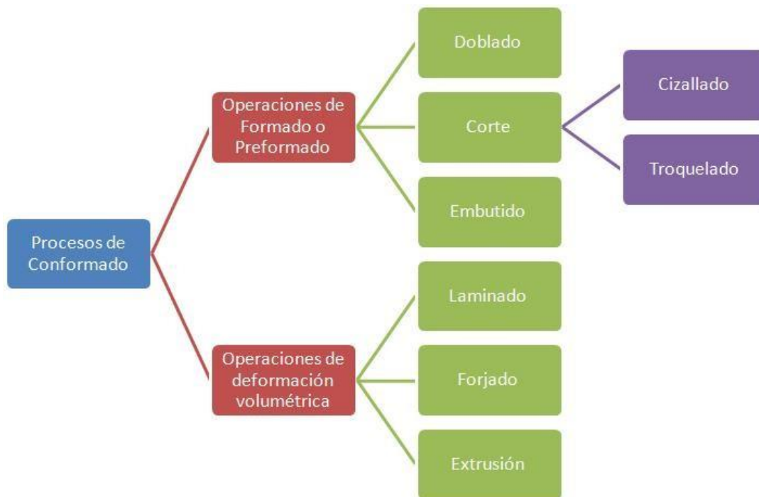
Figura 2.3 Tipos de procesos de conformado
