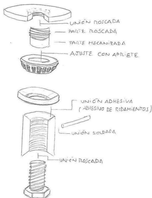
Figura 3.17 Diseño inicial de la sujeción inferior
