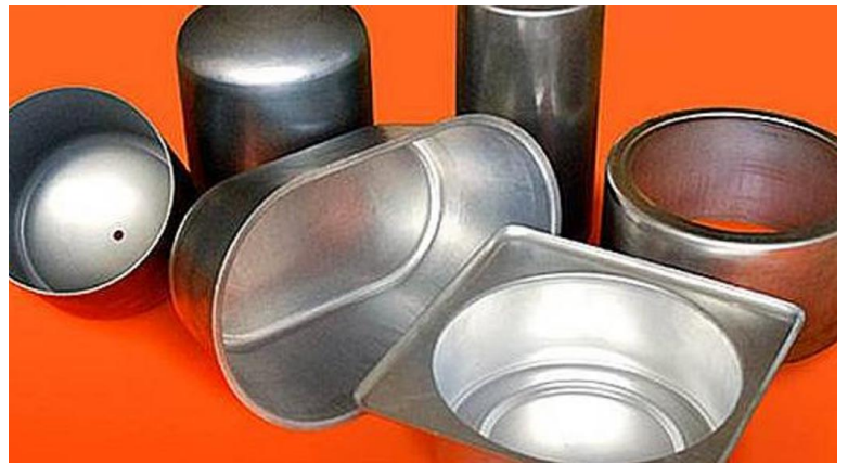
Figura 2.13 Distintos recipientes resultado de la embutición ( https://images.google.com/ )
