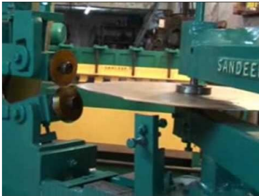
Figura 2.11 Cizalla circular realizando el corte de chapa. https://www.youtube.com
