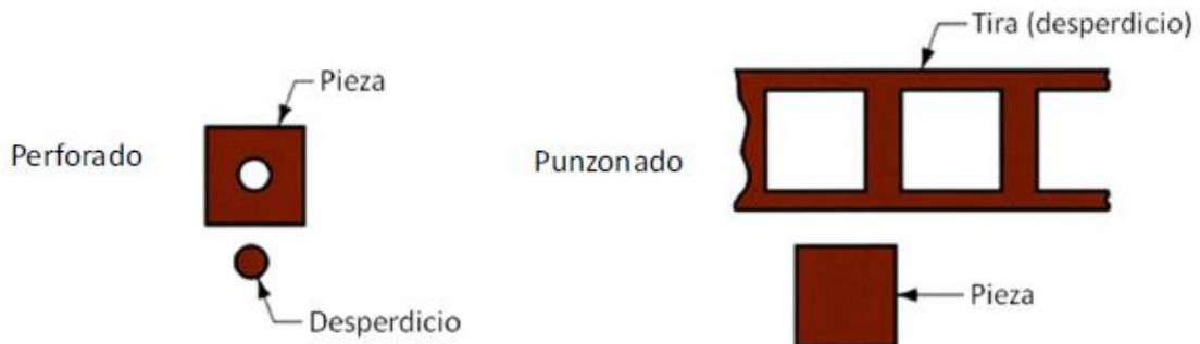
Figura 2.7 Operaciones de perforado y punzonado
