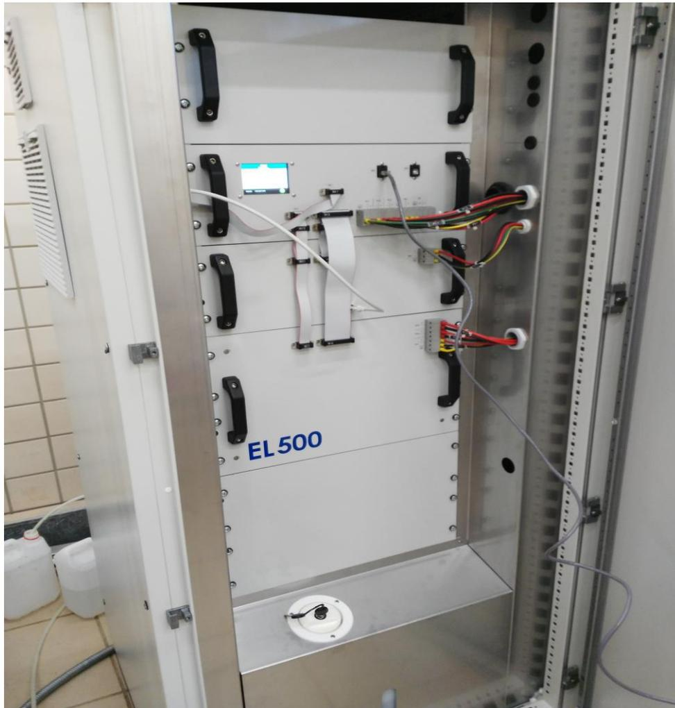
**Figura 11. Electrolizador ELS 500 que se encuentra en el laboratorio.**
