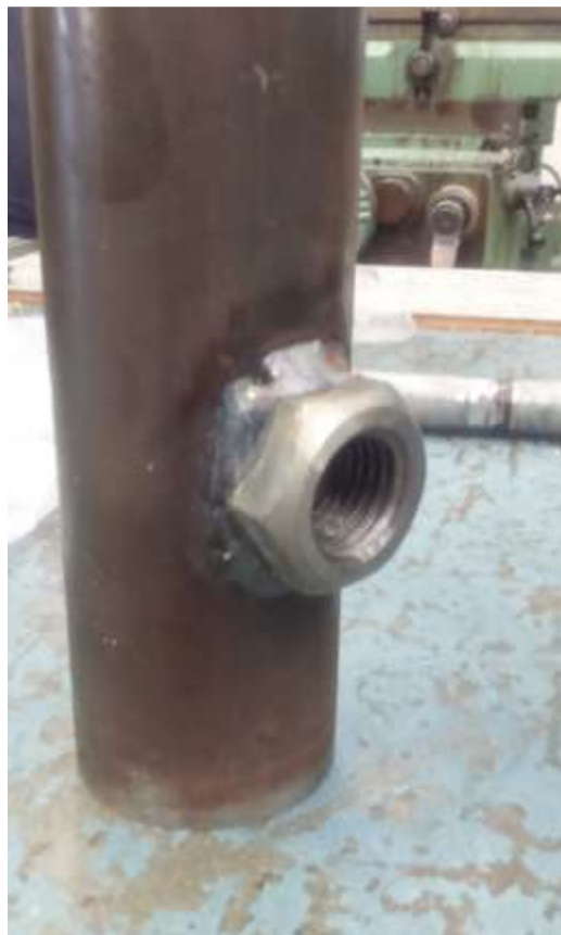
Figura 3-4. Tuerca soldada al tubo
