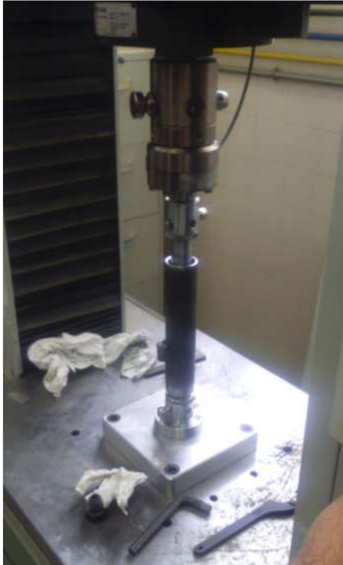
Figura 4-6. Pistón bajado hasta el tope inferior de la extrusora
