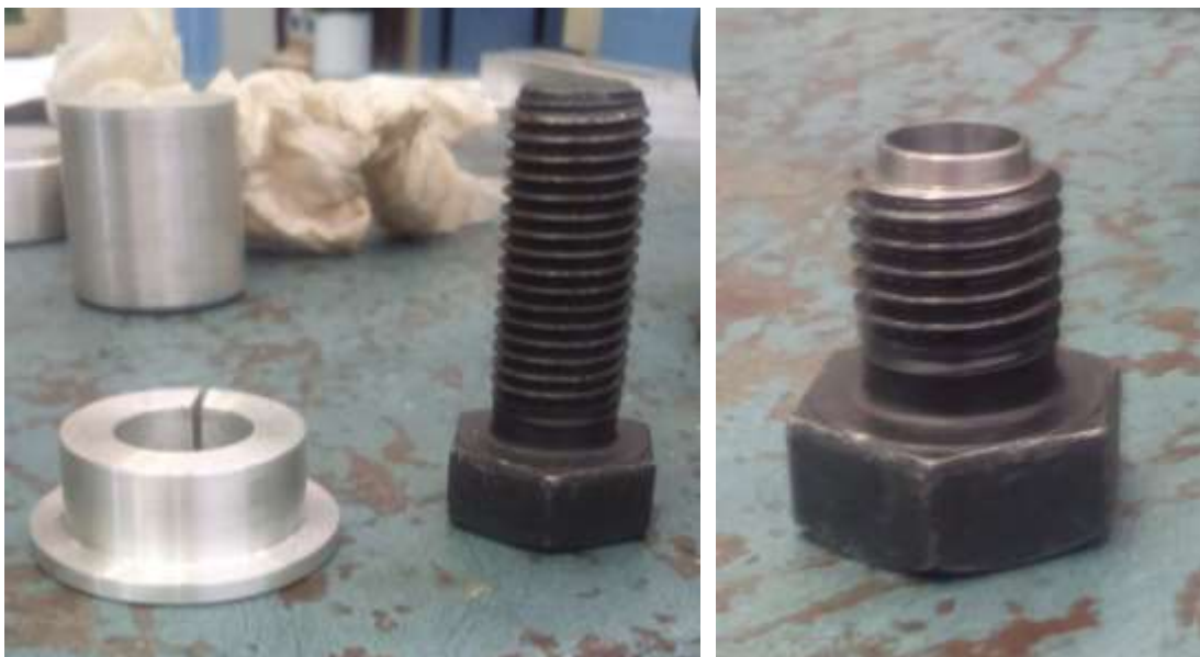
Figura 3-8 y 3-9. Tornillo y matriz de 12 mm de diámetro fabricada a partir del tornillo
