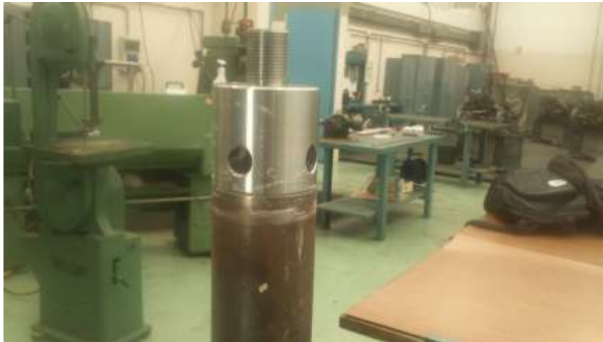
Figura 3-1. Tubo con respecto a la cogida superior de la máquina universal
