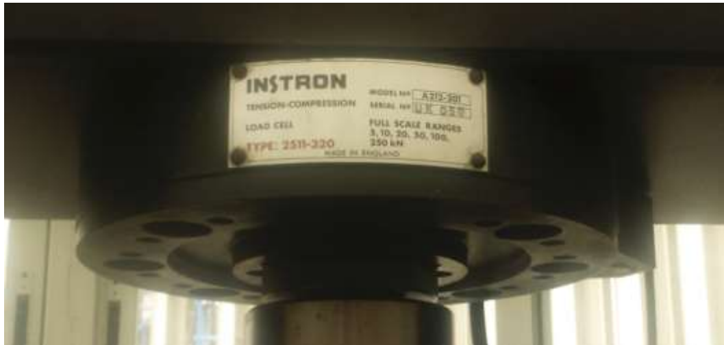
Figura 2-15. Máquina universal para someter materiales tanto a tracción como a compresión
