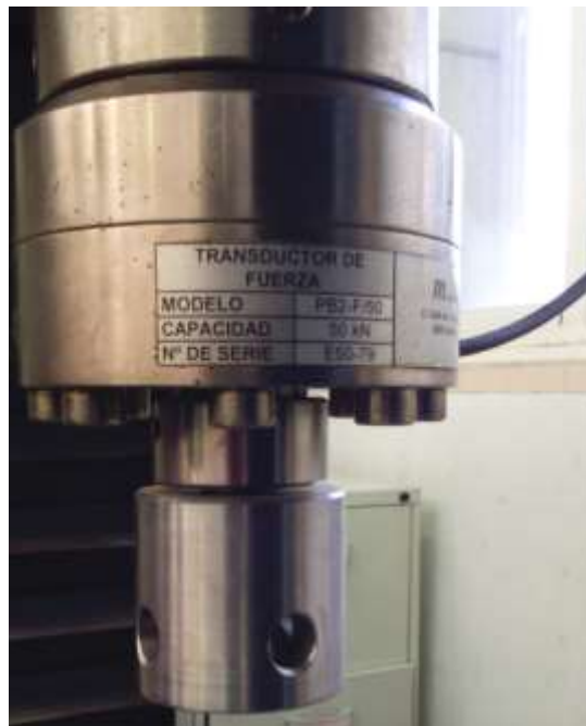
Figura 4-1. Célula de carga de 50 kN de la máquina universal
