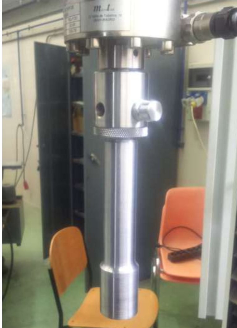
Figura 3-12. Pistón colocado en la cogida superior de la máquina
