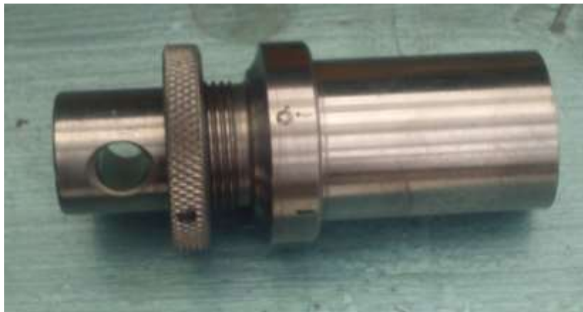
Figura 3-6. Macho interior terminado y con su tuerca de apriete
