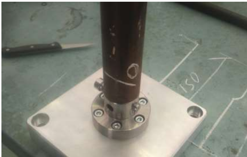
Figura 3-2. Tubo con respecto a la cogida inferior de la máquina universal
