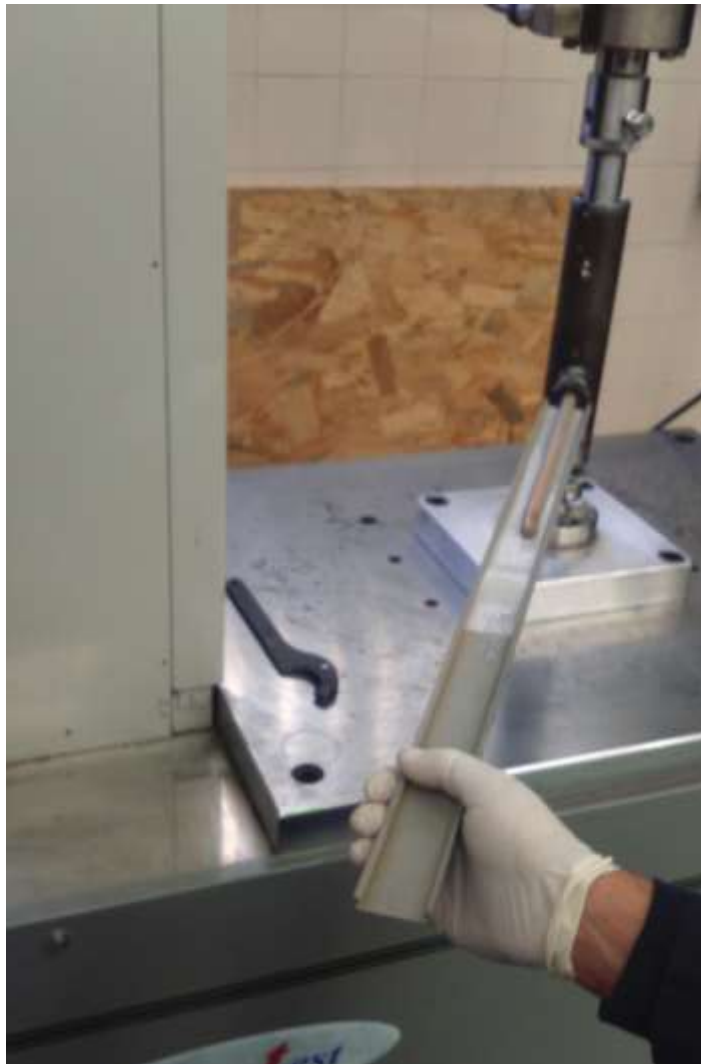
Figuras 4-19. Recogida del producto extruido con la matriz
