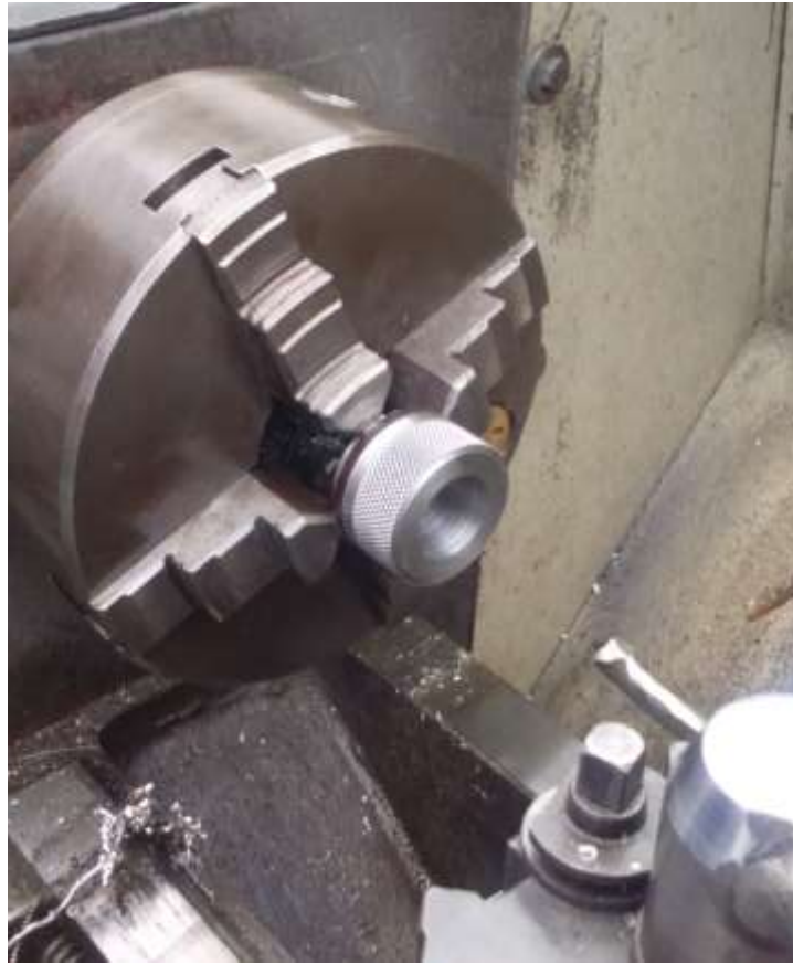
Figura 3-13. Fabricación de las tuercas de apriete
