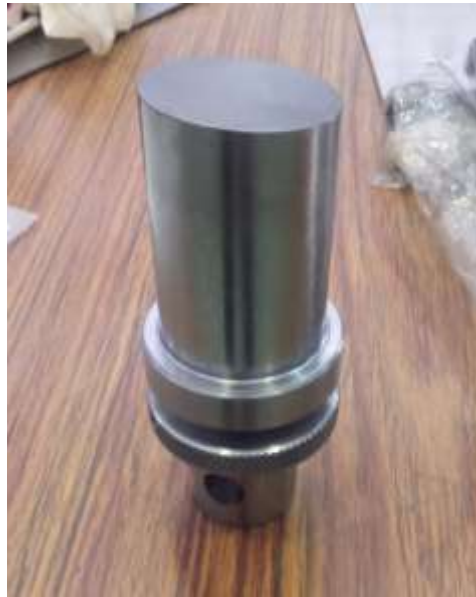
Figura 3-7. Vista de perfil del macho interior terminado y con su tuerca de apriete
