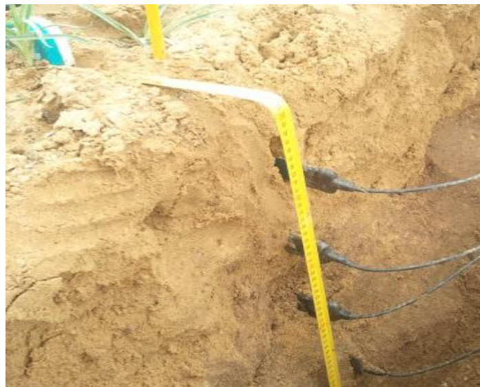
Imagen 12. Sondas de humedad del suelo ECH2O colocadas a 10, 20, 30 y 40 cm.
