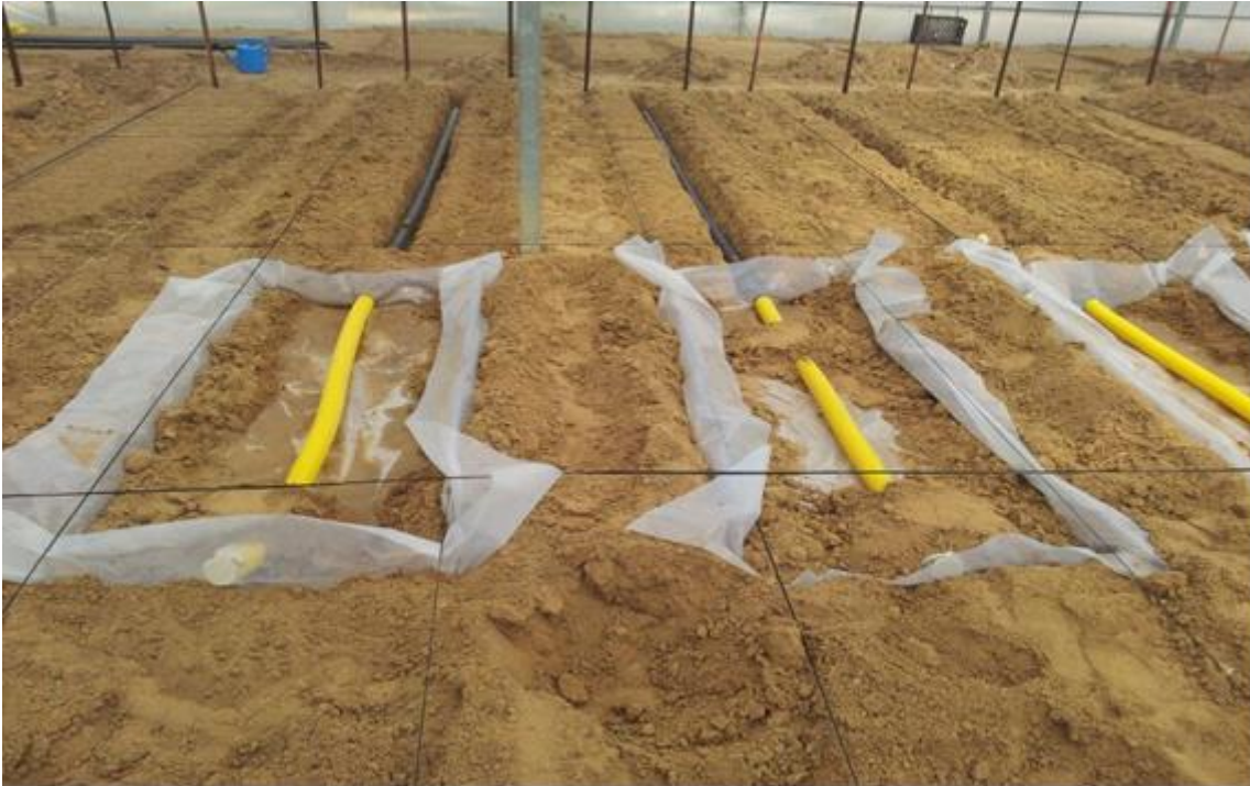
Imagen 8. Lisímetros de drenaje por gravedad, fabricados con plástico transparente, tubos corrugados de PVC y tubos de PVC para conducir el agua recogida hasta los colectores de lixiviados situados al final de cada banqueta.
