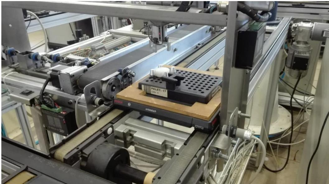
*Figura 3.5.2. Sensor de barrera, siendo cortado por una bandeja a su paso.*
