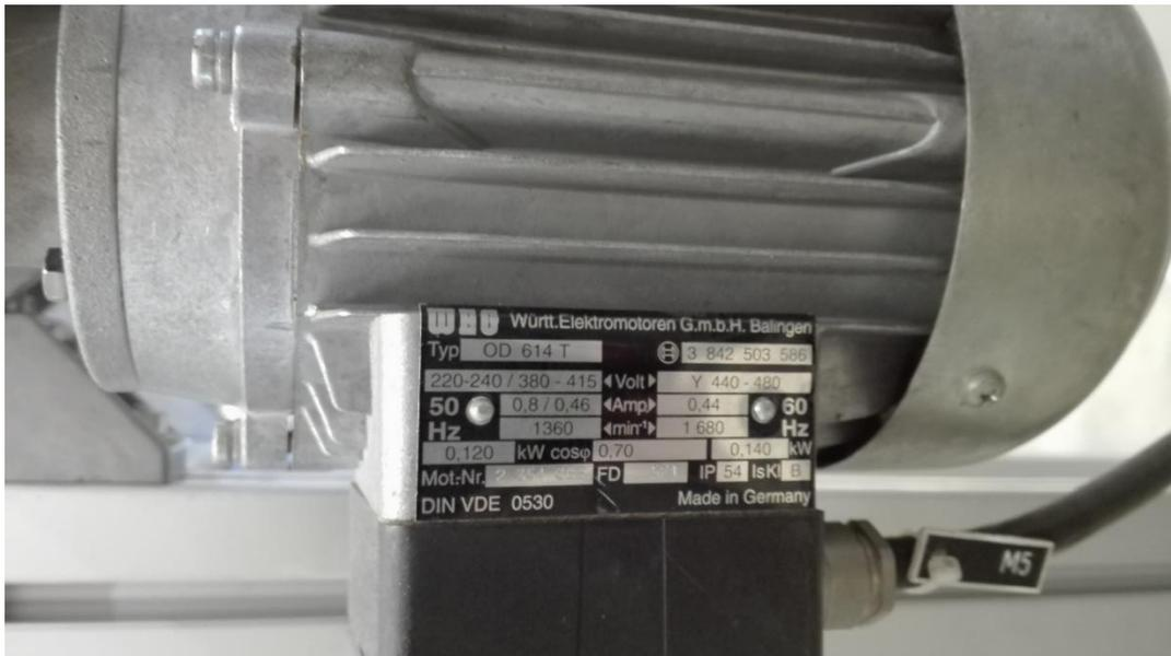
Figura 3.2.1. Chapa informativa del motor utilizado en el proyecto
