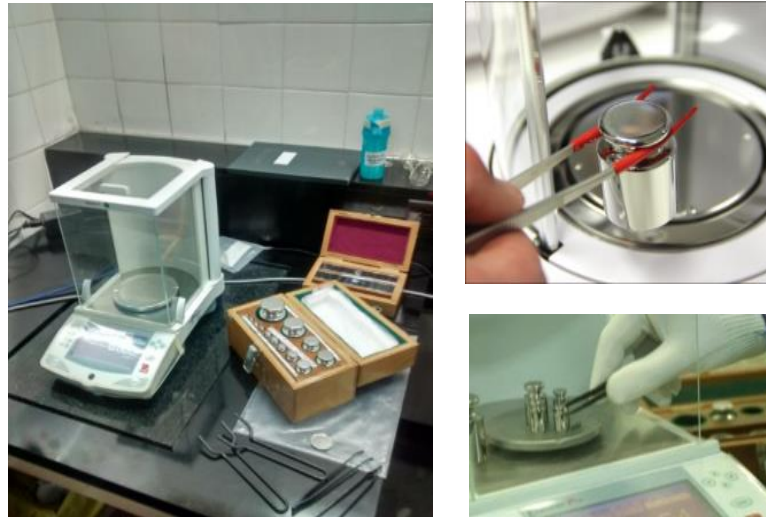
Figura 3. Calibración de una balanza analítica usando pesas certificadas.
