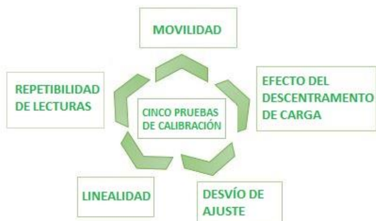
Figura 4. Etapas del procedimiento de calibración de una balanza analítica.
