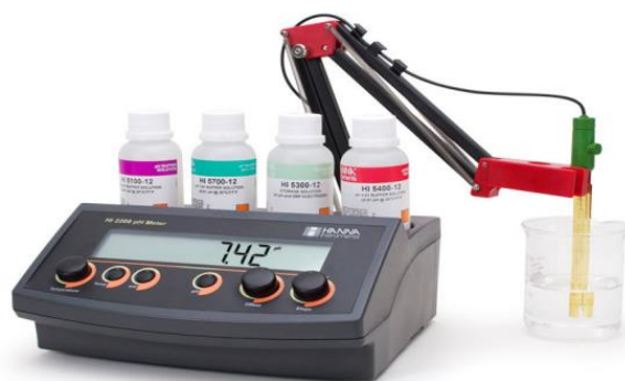
Figura 6. Disoluciones de referencia para calibración pH-metro.
