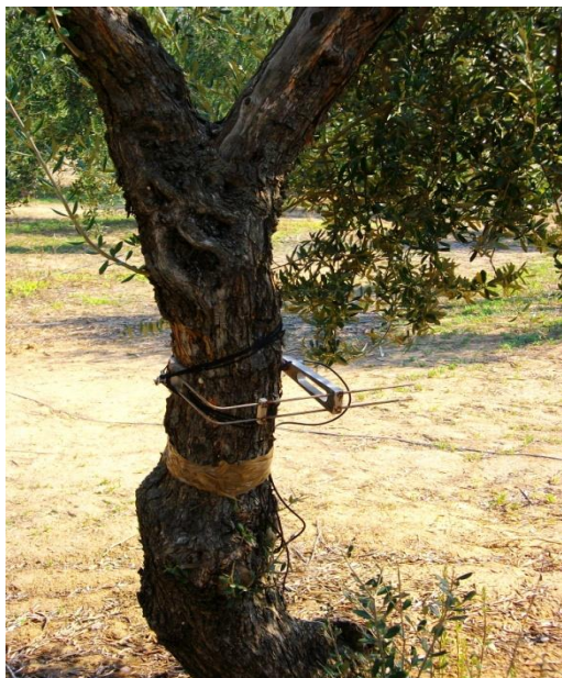
Foto 5. Portasensor colocado en un árbol experimental.
