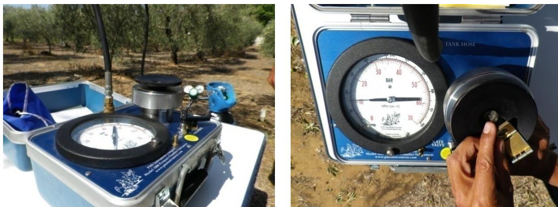
Foto 2. Izquierda: cámara de presión. Derecha: detalle de medida del potencial hídrico.
