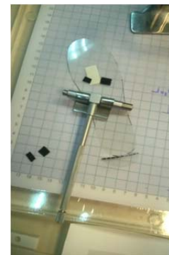
Figura 13.- Colocación del calibre sobre la palmilla para medir la anchura
