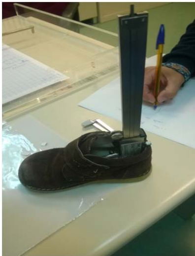
Figura 10 y 11.- Toma de medida de la alturas con el pie de rey calibrado digital.
