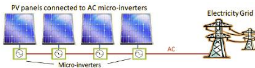
Ilustración 6: Conexión módulos fotovoltaicos con microinversores CC-AC.[2]
