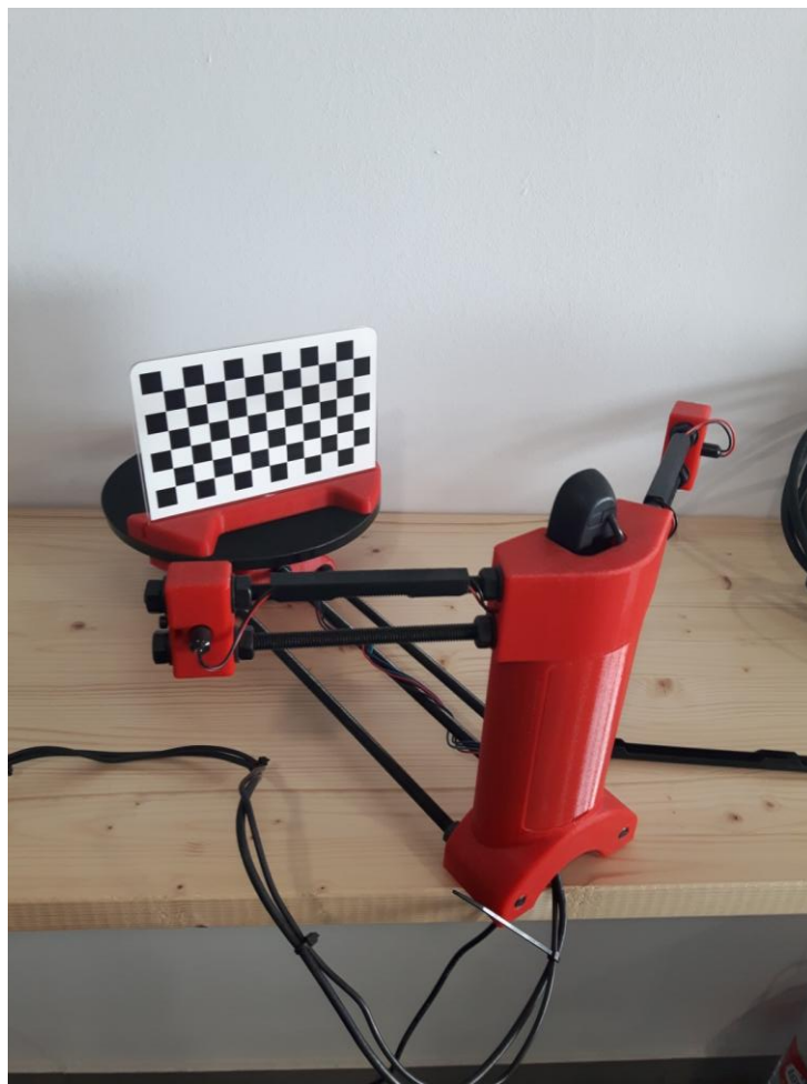
Ilustración 9: Escáner con patrón de calibración
