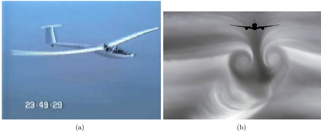
Figura 2: Modo asimétrico de flameo en un velero (a) y estela tras un avión que puede afectar seriamente al control de otros aviones que la atraviesen (b).
