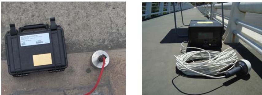
Fig. 2. Acelerómetros usados durante los ensayos.
