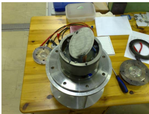
Figura 1.26. Portamuestras del acelerador de partículas para implantar a 45°.
