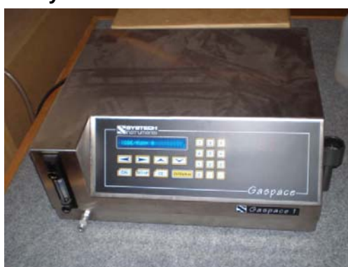
Figura IV.10. Ensayo de carbonatación. Analizador de gases
