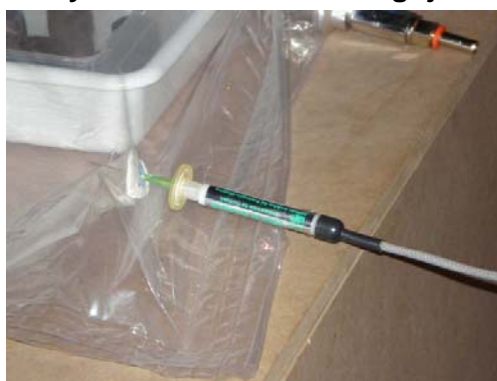
Figura IV.11. Ensayo de carbonatación. Aguja del analizador
