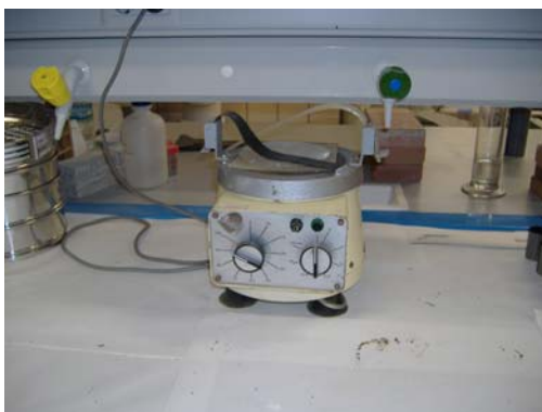
Figura IV.2. Equipo de vibración usado para el llenado de los moldes
