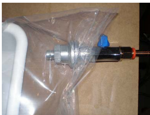
Figura IV.9. Ensayo de carbonatación. Válvula de bola
