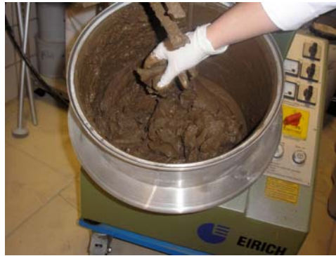
Figura IV.6. Equipo mezclador durante la preparación de pastas geopoliméricas
