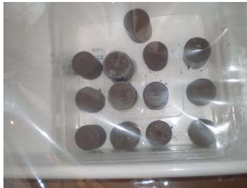
Figura IV.7. Ensayo de carbonatación. Probetas dentro de la bolsa de plástico
