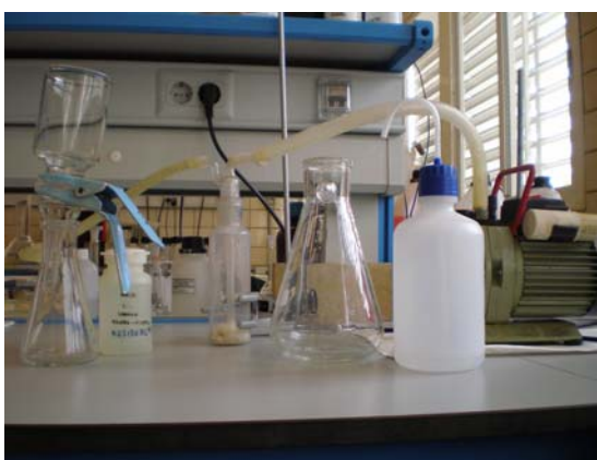
Figura IV.16. Montaje de la filtración en los ensayos de lixiviación
