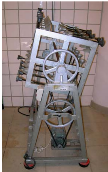
Figura IV.15. Volteador utilizado para ensayos de lixiviación
