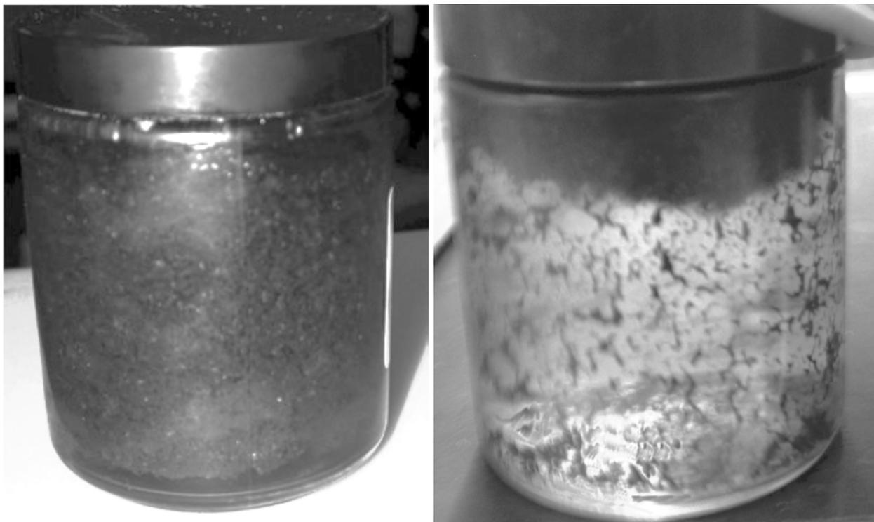
Figura 4.5. Muestras de crudos estable (izquierda) y mesoestable (derecha)
