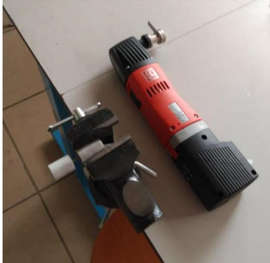
Figura 22. Montaje para el corte de huesos
