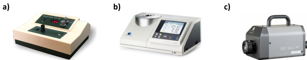
Figura 10: a) Colorímetro; b) Espectrofotómetro; c) Espectrorradiómetro.
