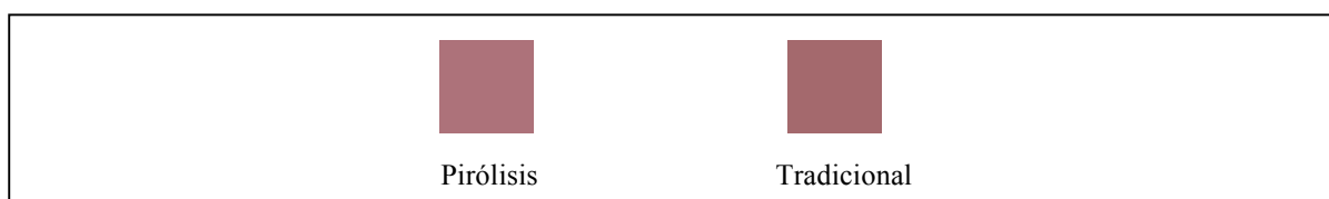
Figura 2.28 Color del pigmento óptimo de Cr-pirocloro preparado por pirólisis de aerosoles, y de una muestra preparada por el método tradicional con el mismo contenido en cromo.
