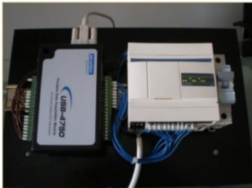
Figura 2-3 Conexiones eléctricas entre la tarjeta DAQ y el PLC
