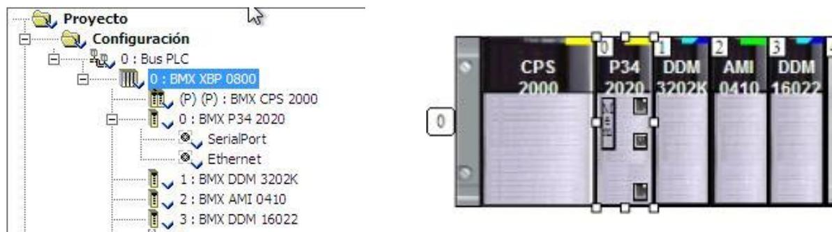
Figura 3-10 Configuración del bastidor.
