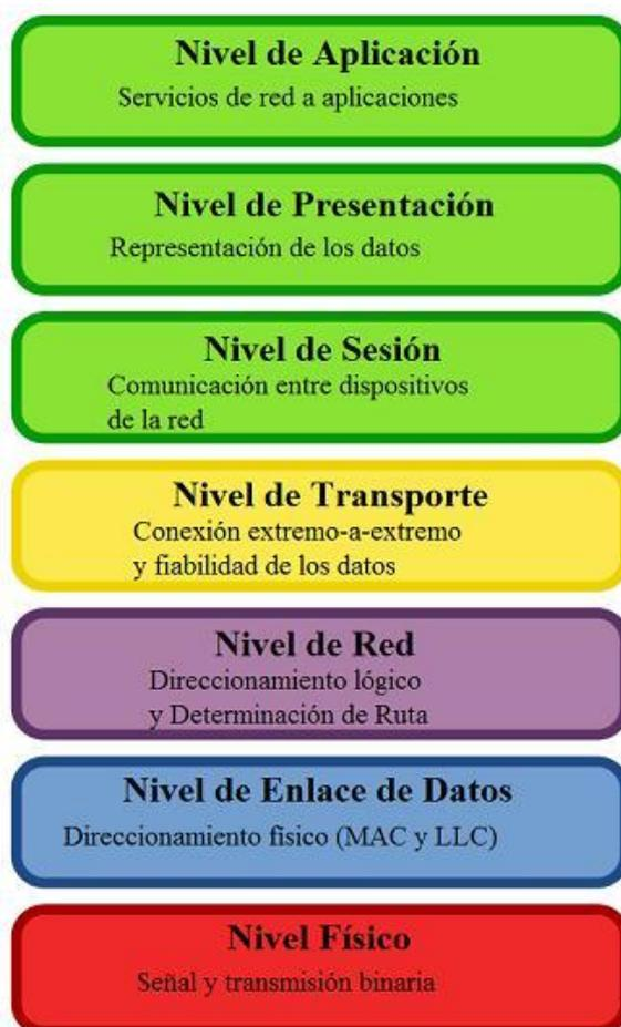
Figura 10-1 Capas del Modelo OSI.
