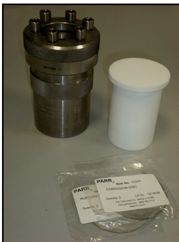
Figura 2.1. Imagen del reactor comercial usado en la síntesis hidrotermal.
