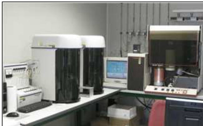
Figura 2.6. Imagen del analizador de fisisorción empleado.
