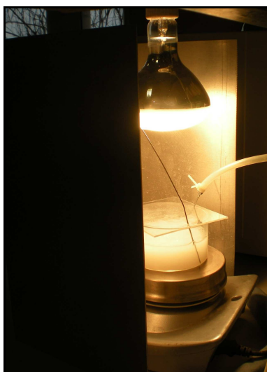
Figura 2.10. Imagen del sistema de reacción empleado en los ensayos de degradación fotocatalítica.
