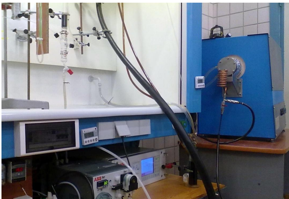
Fig. 5. Instalación de las pruebas de adsorción y horno tubular
