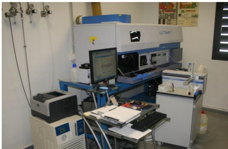
Fig. 9. Espectrómetro de emisión atómica mediante fuente de acoplamiento de plasma inductivo
