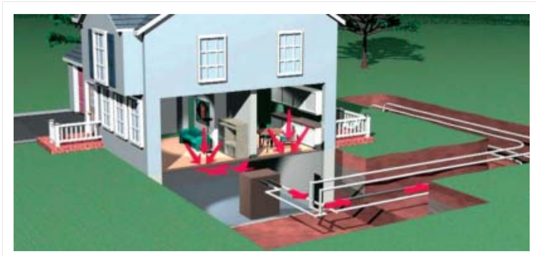
Figura 2-5. Instalación geotérmica tipo en edificio.
