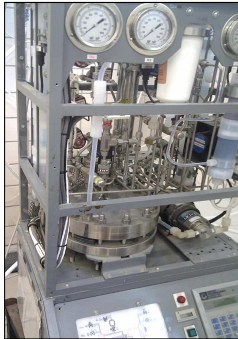
Figura 3.3.2.2. Fotografía del electrolizador PEM de 1 kWe Hamilton.
