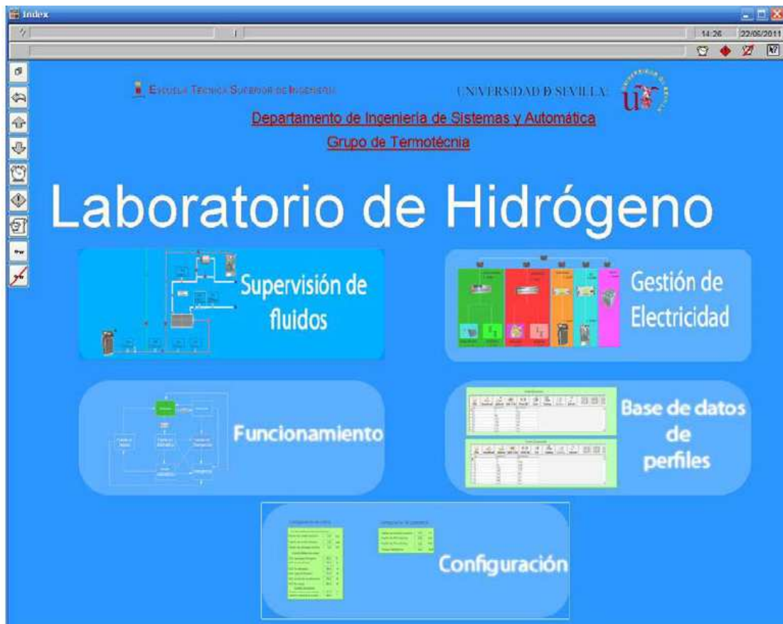
Figura 3.2.6. Pantalla principal del sistema SCADA
