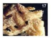
Sobre la madera tiene pegada con cola orgánica una tela fina de lino de 18 hilos de trama x 20 de urdimbre por cm2, técnica del entelado muy empleada en la
