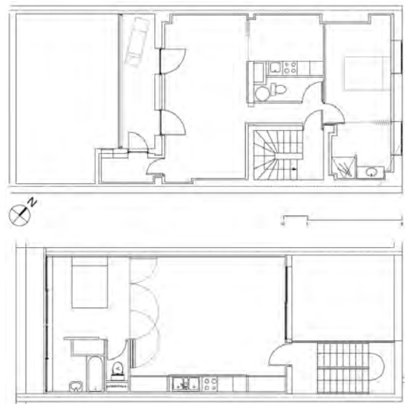
Figura 3. Reestructuración de las plantas de vivienda mediante la flexibilización y desjerarquización del programa: calle Larroche (superior) y Minvielle (inferior). Cada una de las tres plantas es transformada en un T2 (1 dormitorio), cuya superficie casi duplica lo exigido por la normativa HLM (80 m2 frente a 41m2). Fuente: Christophe Hutin.
