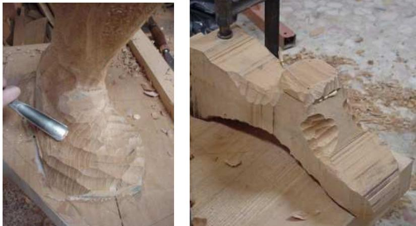
Fig.7 y 8. Proceso manual de talla directa sobre el embón rodeado de máquina.
