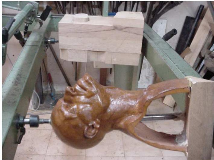
Fig. 13 Modelo previo y embón colocados en el pantógrafo para su reproducción.
