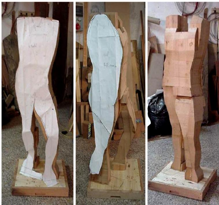
Fig. 8, 9 y 10. Embón configurado por plantillas.
