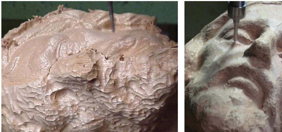
Fig. 16, 17 Proceso superficial del desbaste y modelado de la obra en el pantógrafo.
