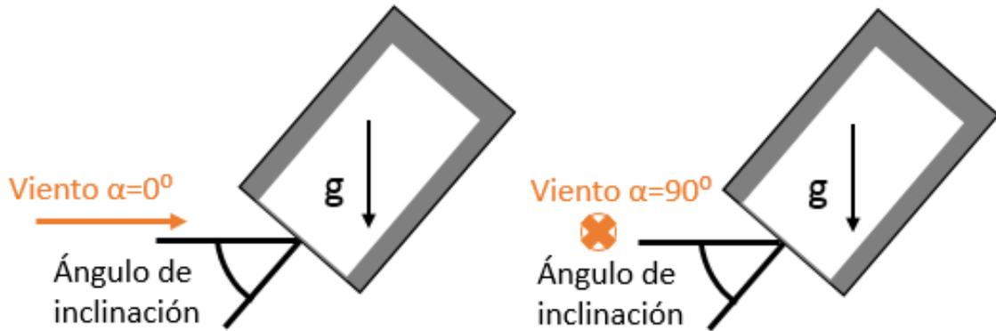
Figura 47. Definición de ángulo de inclinación del reactor solar. Izq: viento de frente ( $\alpha=0^\circ$ ); Drch: viento de lado ( $\alpha=90^\circ$ ).
