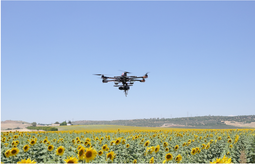
Figura 1.2: Dron capaz de realizar un seguimiento continuo de cultivos y detectar problemas que a vista de suelo pasan desapercibidos como zonas sin sembrar, con falta de crecimiento por diferencias en el suelo,etc [4].
