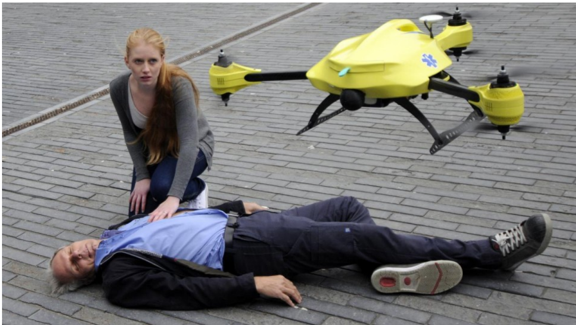
Figura 1.1: Dron-ambulancia:transporta un desfibrilador, vuela a 100 km/h y puede llegar al lugar de los hechos en un minuto [3].
