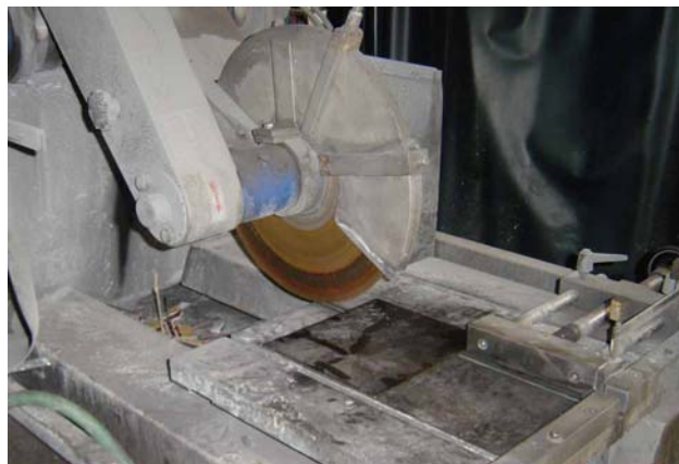
Fig. 4.6.- Disco de diamante refrigerado por agua para el corte de fibra de carbono.
