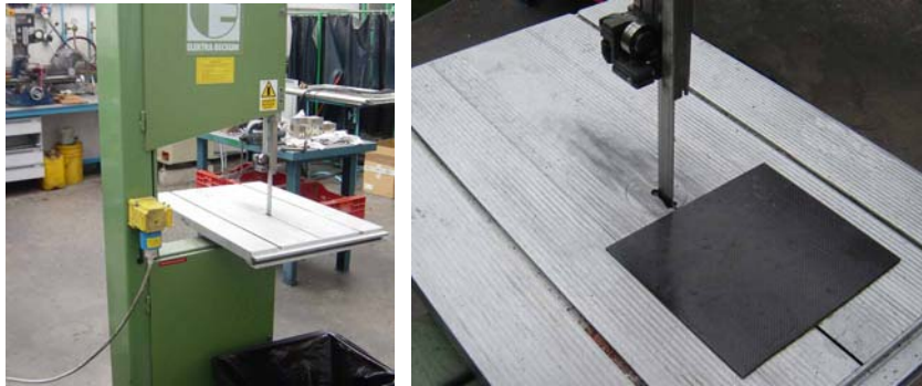
Fig. 4.5.- Sierra de cinta vertical para el corte de materiales metálicos.
