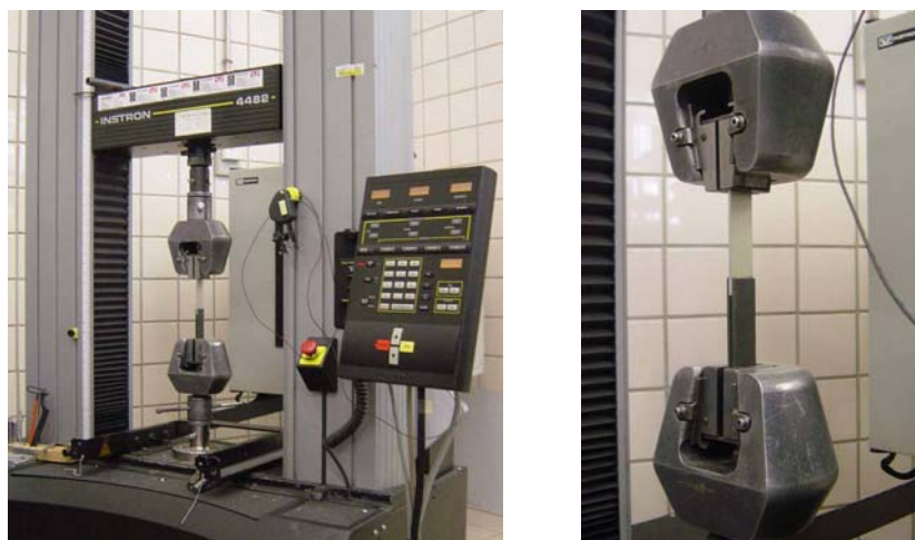
Fig. 4.8.- Máquina universal de ensayos utilizada (y detalle).
