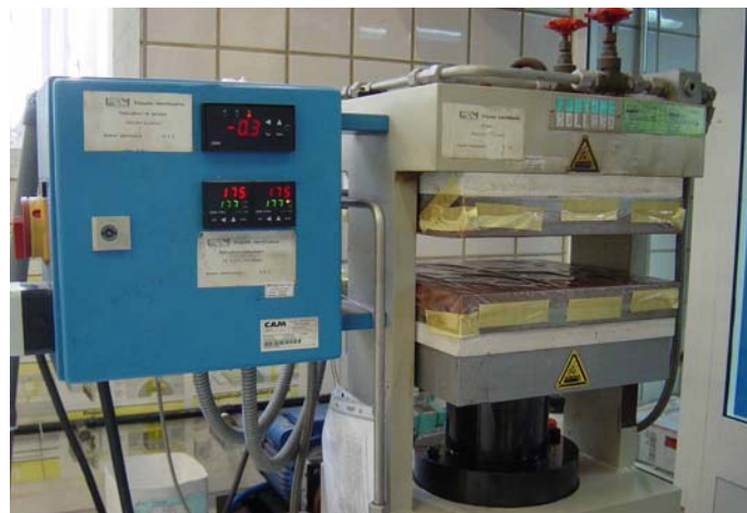
Fig. 4.2.- Prensa de platos calientes utilizada para el curado del adhesivo.
