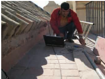
Figura 1: Medidas dinámicas en la cubierta de la Iglesia del Salvador.
