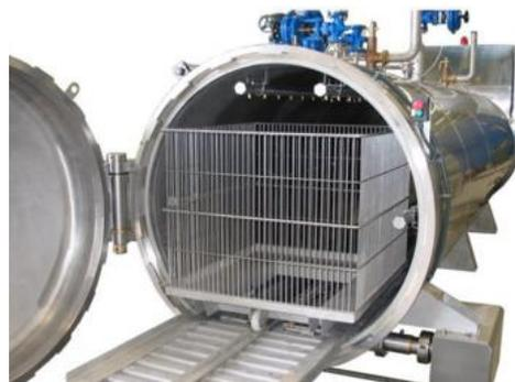
Figura 35: Autoclaves horizontales.
