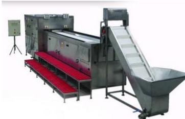
Figura 10: Maquinaria corte y eviscerado.
