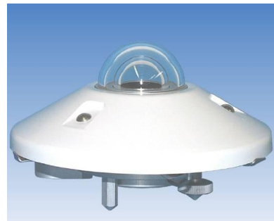
Figura 3.9. Piranómetro Kipp & Zonen, modelo CM6b.
