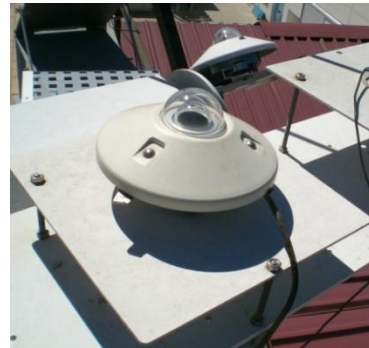
Figura 3.8. Piranómetro Middleton SK01-D.
